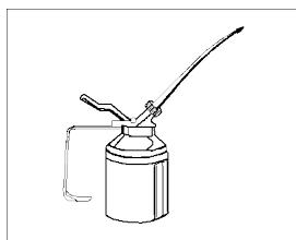
Verschraubungen und O-Ringe mit Kältemittelöl versiehen
