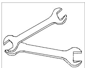
Zwei Schraubenschlüssel verwenden, um die Verbindungen der Kältemittelleitungen gleichmäßig zu lösen oder festzuschrauben
