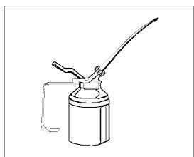
Appliquer de l'huile de réfrigération sur les raccords vissés et les joints toriques
